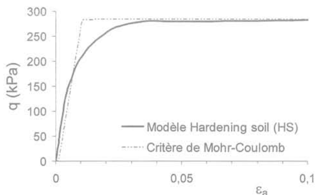
FIG. 1 Simulation d'un essai triaxial drainé sur sable selon différents modèles ( E_{50}^{ref} = E_{ur} = 34 MPa ; \nu = 0,3 ; \varphi' = 35^\circ ; \psi = 7^\circ et c' = 0 ). Modelling a triaxial drained test with different constitutive models.
