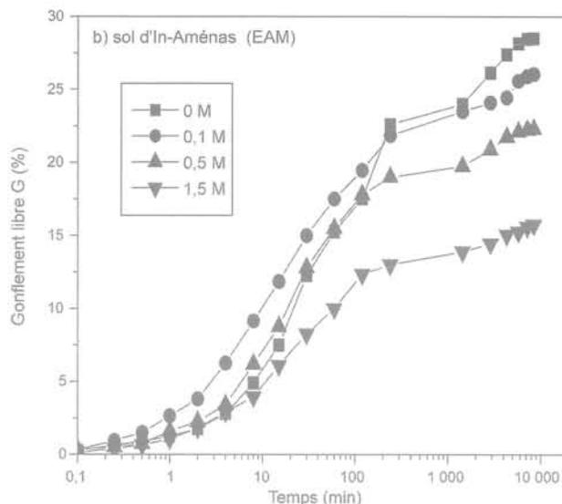
FIG. 11 Évolution du gonflement libre en fonction du temps (sable + solution saline NaCl).
