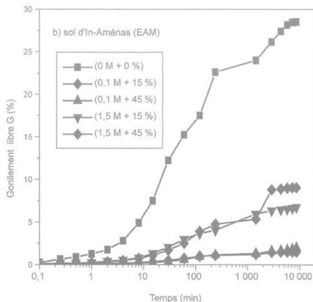
**FIG. 12** Évolution du gonflement libre en fonction du temps (sable + solution saline NaCl).
