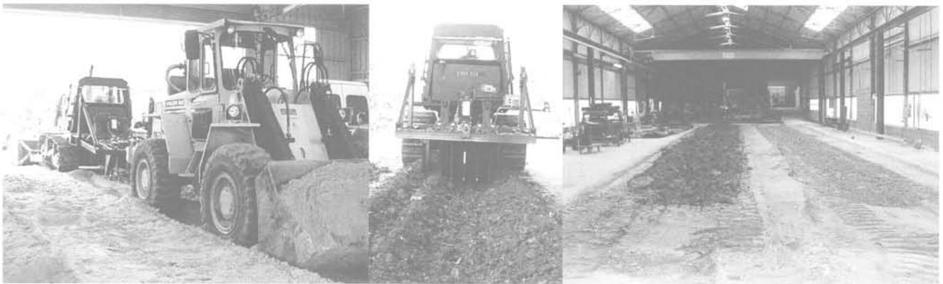
FIG. 5 De gauche à droite, essai de capacité de traction sur sable, charrue expérimentale de scarification, fosse d'expérimentation avec sol A1 à gauche et B5 à droite.
