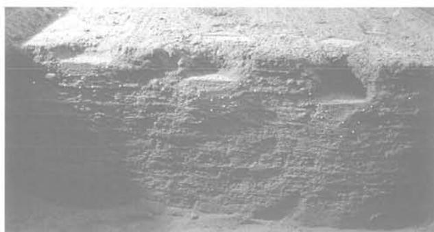
FIG. 16 Coupe transversale du sable limoneux SL bicouche (NSRI, UK) : visualisation des mécanismes de déformation lors des essais d'enfoncement.
