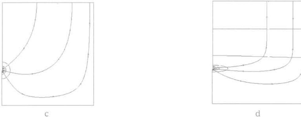
FIG. 4 Équipotentiellles et lignes de courant ( $L/D = 2$ ). (c) cas isotrope ; (d) cas anisotrope ( $k_h/k_v = 25$ ).
