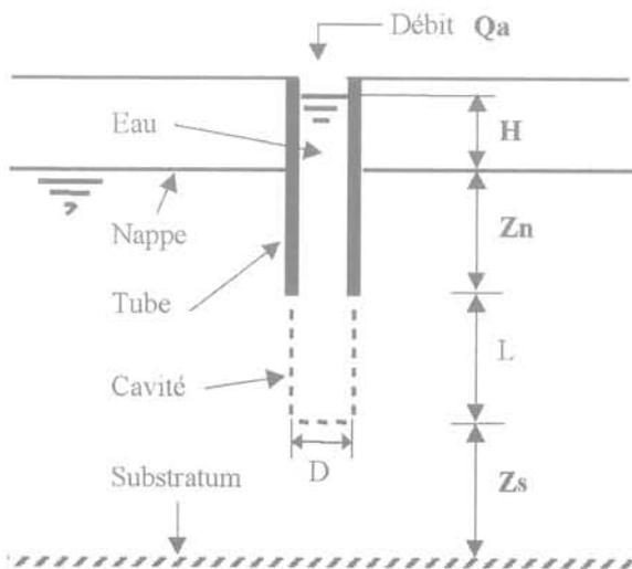
FIG. 1 Essai Lefranc : principe et notations.
