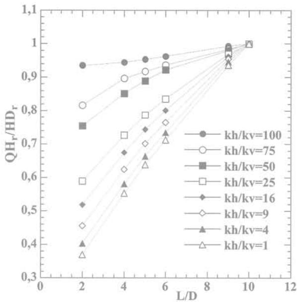
FIG. 6c Variation du débit normalisé en fonction de l'élongement de la cavité dans un sol anisotrope ( $L_r/D_r = 10$ ).
