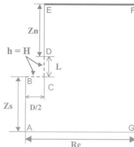
FIG. 2 Modélisation de l'essai Lefranc. Géométrie et notations.
