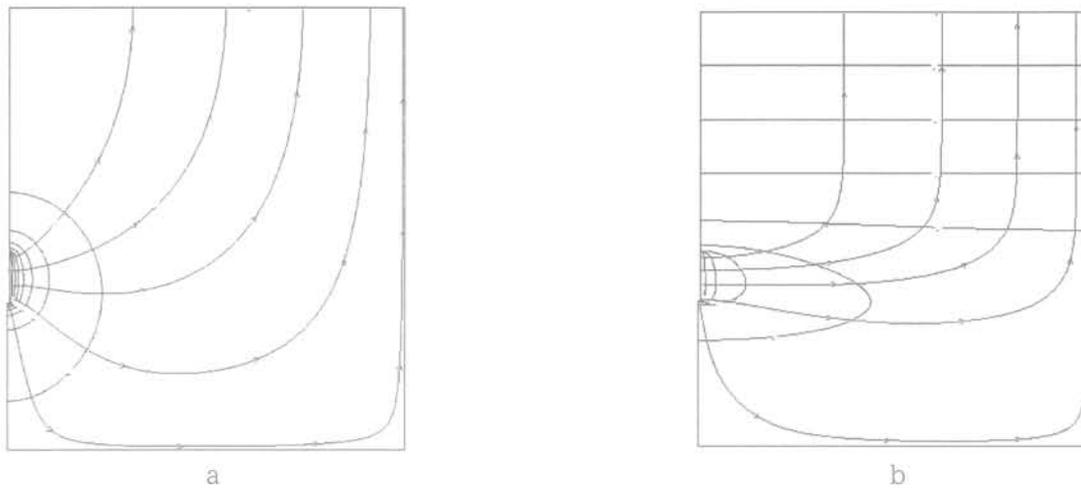
FIG. 3 Équipotentiellles et lignes de courant ( $L/D = 10$ ). (a) cas isotrope ; (b) cas anisotrope ( $k_h/k_v = 25$ ).
