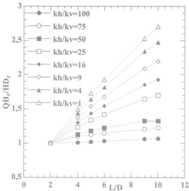
FIG. 6a Variation du débit normalisé en fonction de l'élongement de la cavité dans un sol anisotrope ( $L_r/D_r = 2$ ).
