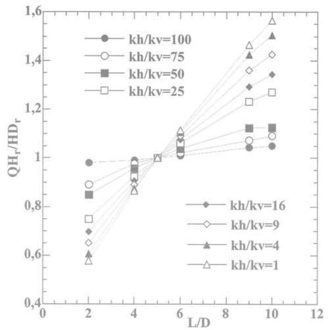
FIG. 6b Variation du débit normalisé en fonction de l'élongement de la cavité dans un sol anisotrope ( $L_r/D_r = 5$ ).
