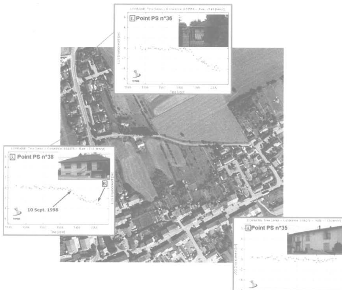
FIG. 5 Sur ce secteur, plusieurs séries temporelles indiquent clairement un affaissement d'environ 2 cm/an depuis 1998 (exemple des points 36 et 38). La stabilité du point 35 est confirmée par des mesures de nivellement sur la période 1997-2000.
