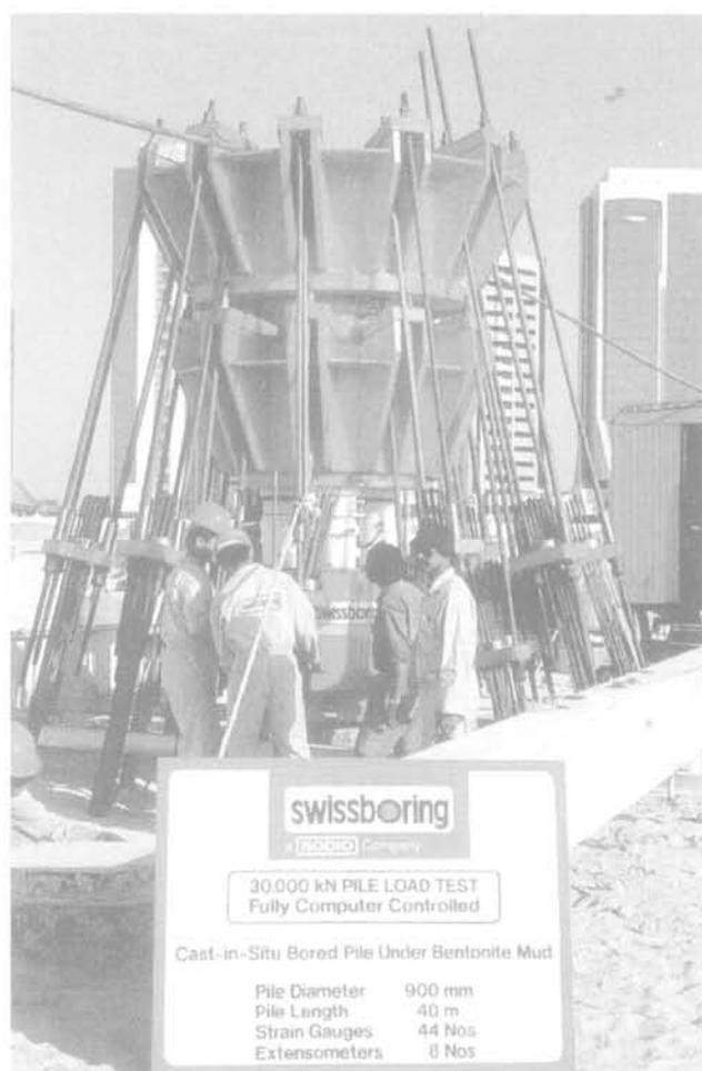
FIG. 3 Préparation d'un essai de chargement d'un pieu instrumenté.
