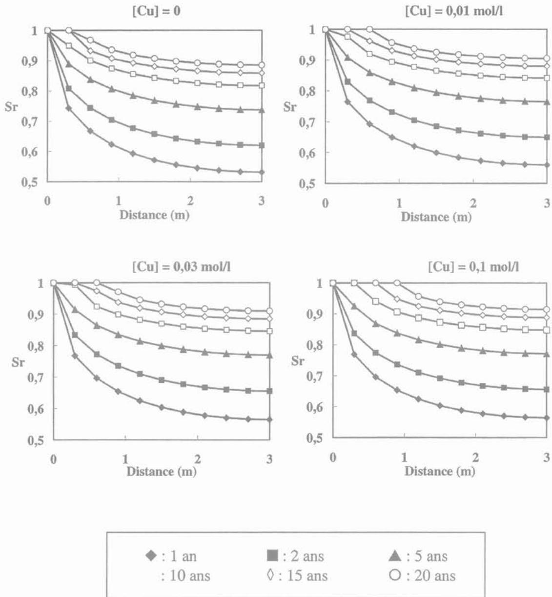
FIG. 10 Simulations de la cinétique de saturation en eau à l'échelle d'un massif d'argile de 3 m de longueur après pollution avec des solutions de nitrate de cuivre.
