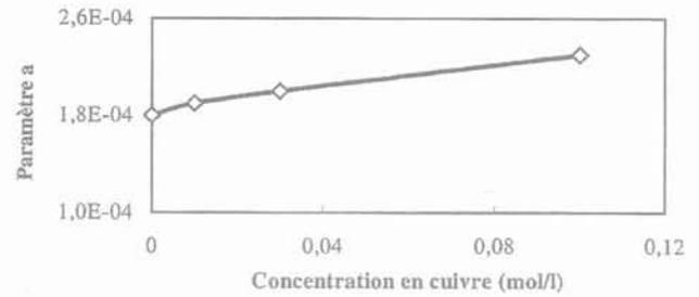
FIG. 8 Exploitation des paramètres mesurés pour la Fo-Ca en vue d'une modélisation du transfert de masse : a) exemple de lissage de courbe de rétention par une fonction hyperbolique pour la Fo-Ca infiltrée à l'eau ; b) évolution du coefficient de la loi en fonction de la concentration en cuivre.
