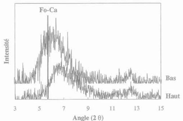
**FIG. 3** Évolution des spectres de diffraction des rayons X de la Fo-Ca après 1 360 heures d'infiltration par une solution de nitrate de cuivre à  $10^{-1}$  mol/l en fonction de la zone de prélèvement en comparaison avec le spectre de la Fo-Ca matérialisé par une droite d'abscisse 5,7 degré en  $2\theta$ .
