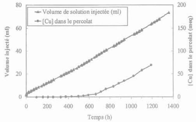
**FIG. 2** Réponse de l'argile Fo-Ca à l'injection d'une solution à  $10^{-1}$  mol/l de nitrate de cuivre en fonction du temps avec l'œdomètre à seringue : a) évolution du volume injecté et de la déformation de gonflement axiale ; b) évolution du volume injecté et de la concentration en cuivre dans le lixiviat.
