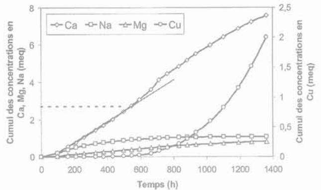
**FIG. 7** Évolution du cumul des concentrations des ions  $\text{Ca}^{2+}$  et  $\text{Cu}^{2+}$  dans le percolat en fonction du temps.
