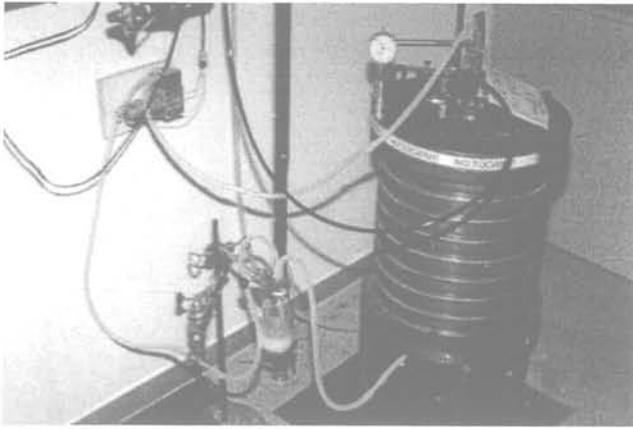
**FIG. 17** Photographie de l'œdomètre Rowe (équipement I) employé dans le programme d'essais.
