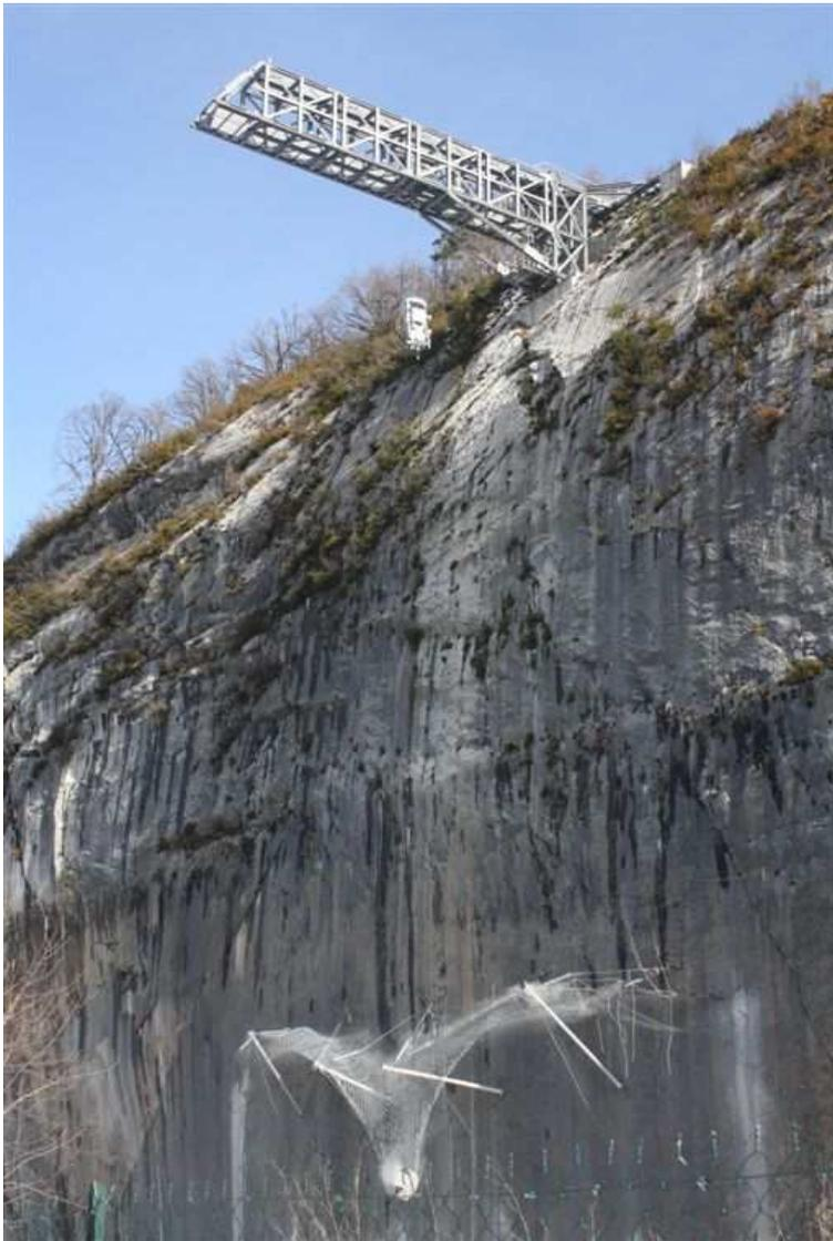
*Photo 3 - Station d'essais de chutes de blocs du LCPC à Montagnole (Savoie) - Essai MEL 3000 kJ sur un écran ELITE® (GTS)*
