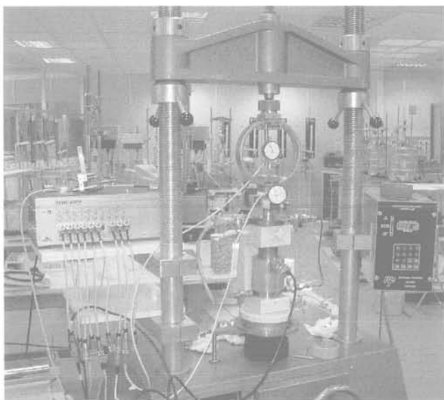
FIG. 7 Essai de gonflement à l'oedomètre K_0 à haute pression. Appareil K_0 , presse triaxiale et chaîne de mesure.
