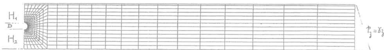
FIG. 3 Maillage du premier modèle pour la détermination des affaissements de surface. Conditions aux limites : pas de déplacement normal au contour du modèle et déplacement tangentiel libre. Mesh of FEM calculation and boundaries conditions.
