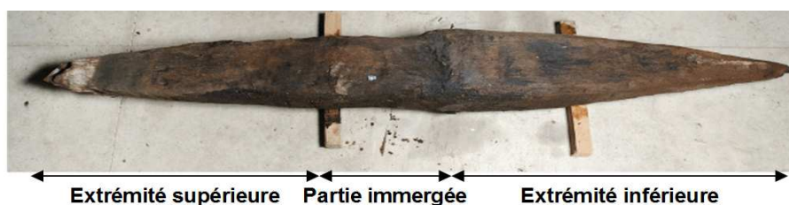
Figure 42. Pieu de fondation du pont mixte de Saint-Satur (Dumont, 2011)
